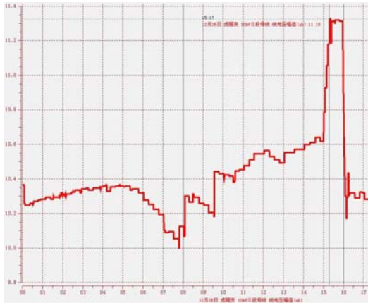
图3 虎踞变10kV II 段母线电压曲线
